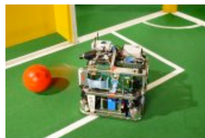
Opengewerkte versie van één van de RoboCup voetbalrobots
